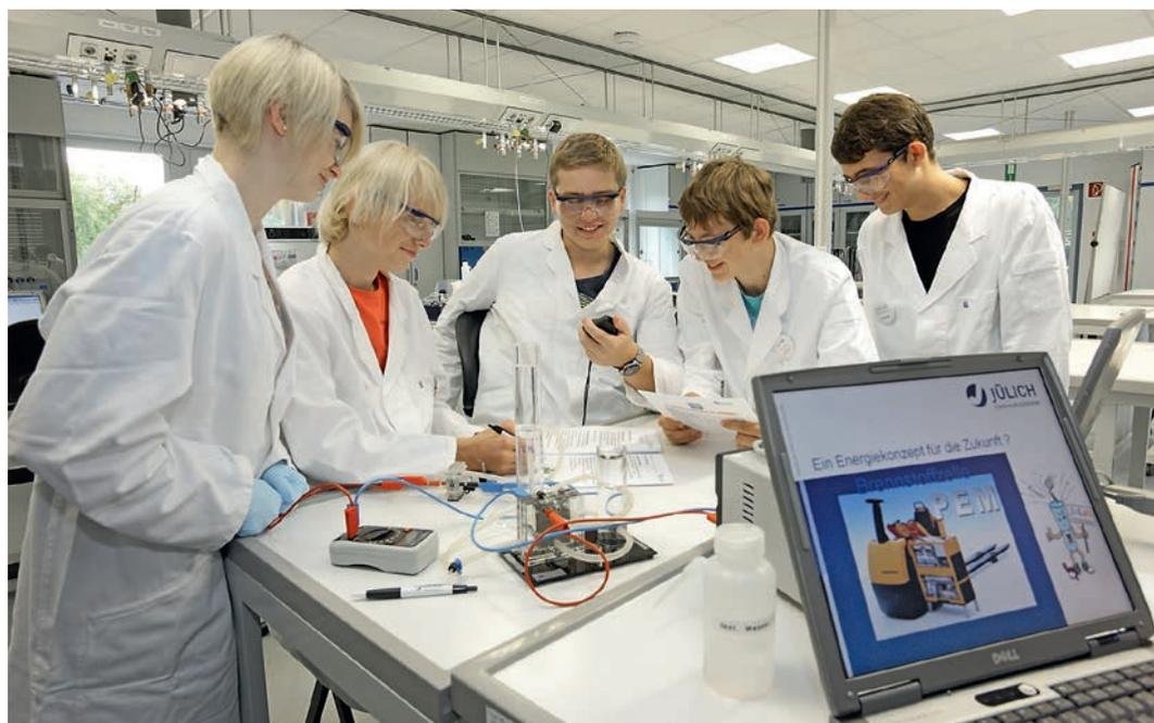
Experimentieren im JuLab mit PEM- und DMFC-Brennstoffzellen.
