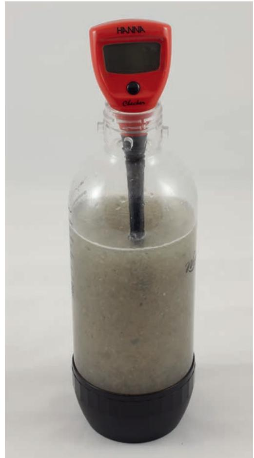
Abb. 1. Das Budenheimer CO<sub>2</sub>-Verfahren wird nachempfunden durch CO<sub>2</sub>-Einpressungen in Recyclinglösungen in einem Trinkwasser-Sprudler und damit verbundene pH-Wert-Änderungen.
