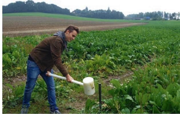
Abb. 3: Expeditionslernen: Ein Bohrstock für Bodenproben wird eingeschlagen.
