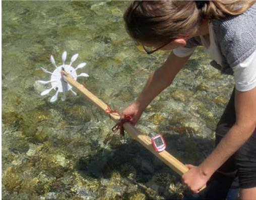
Abb. 1: Strömungsgeschwindigkeit messen mit selbst gebautem Messgerät.
