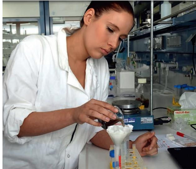
Abb. 3: Eine Schülerin filtert die fiktive Wasserprobe nach der Inkubation mit Aktivkohle über einen Papierfilter
