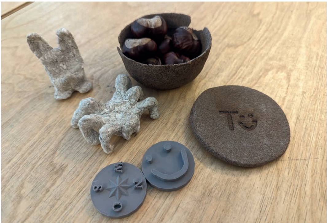
Materialherstellung aus Papier und Kaffeesatz, das mit Makermaschinen bearbeitet werden kann.
